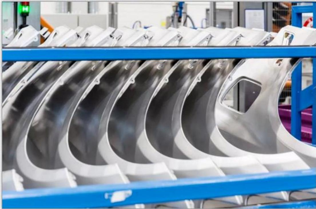
碳纤维复合材料是一种高性能新型材料，具有优异的比强度、比模量、耐腐蚀、抗疲劳等优点。碳纤维增强塑料汽车翼子板相对于传统的钣金翼子板：1) 可减重 45% 以上，轻量化效果显著，节能减排的优势明显；2) 物理化学性能稳定，不易氧化生锈，耐腐蚀性强、寿命长；3) 尺寸稳定性好，提高与翼子板相关的附件的匹配精度；4) 较高的阻尼系数和疲劳强度极限，减震性能和抗疲劳性能强；5) 特殊的纹理图案显示。随着中国汽车保有量不断增长，以及受主要消费群体年轻化、需求个性化等
